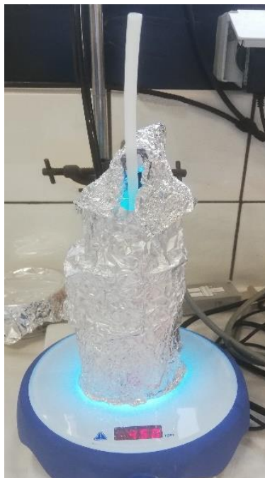
Fig. 2.13 (b) Reactorul fotocatalitic utilizat pentru testarea materialelor obținute cu o capacitate utilă de 0,25 L
