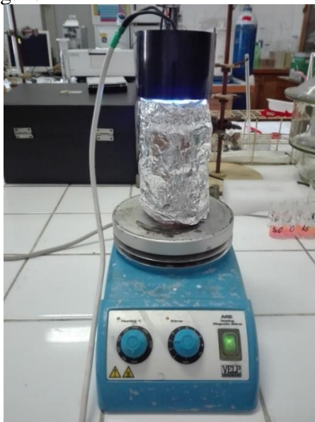
Fig. 2.12. Reactorul fotocatalitic utilizat pentru testarea preliminară a materialelor obținute (volum util de 0,25 L)
