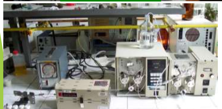
Instalatie de extractie SCF
