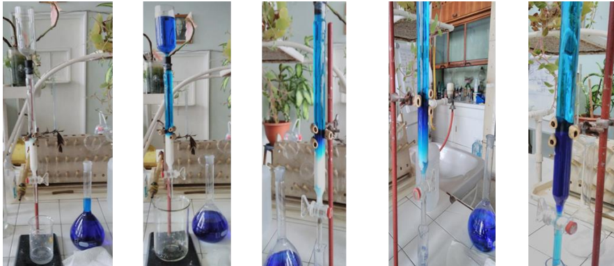
Figura 3.12. Etape în cazul biosorbției pe coloana umplută cu celuloză microcristalină Cellets
