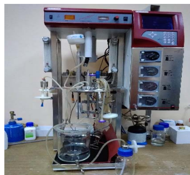
Figura 6. Bioreactorul cu amestecare mecanică Fermac 360, Electrolab (foto original).
