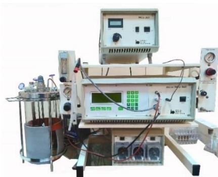
Figura 4. Bioreactorul cu amestecare mecanică Biostat B Braun Biotech International (foto original).
